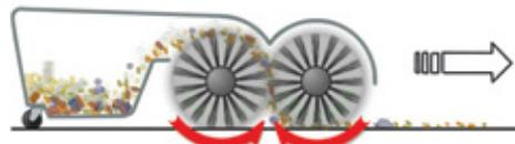
La tecnología TwinMax está diseñada para barrer múltiples superficies en interiores y exteriores y proporciona la máxima versatilidad para la limpieza en cualquier momento y en cualquier lugar.
