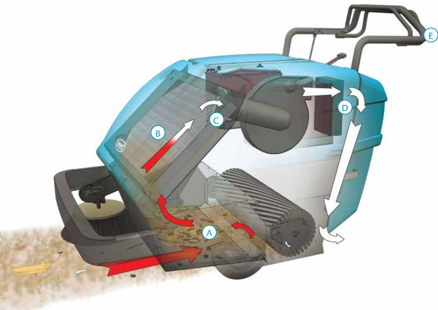
**A** **Bac à déchets à grande capacité** – le bac à déchets flottant peut contenir jusqu'à 150 lb/68 kg, 2,8 pi<sup>3</sup>/79 l de débris.
