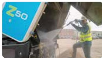
Limpie los equipos de manera eficiente y elimine los residuos con la **lavadora a presión opcional**.
