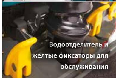
Водоотделитель и желтые фиксаторы для обслуживания
