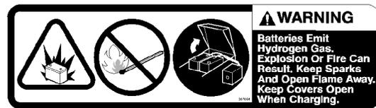
**BATTERY CHARGING LABEL - LOCATED ON THE LINTEL.**
