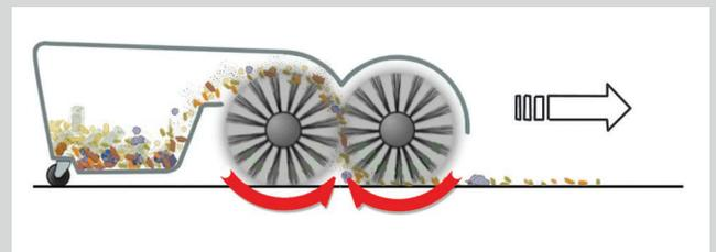
La technologie TwinMax est conçue pour le balayage de multiples surfaces à l'intérieur comme à l'extérieur, en vous offrant une polyvalence maximale pour nettoyer n'importe où et à tout moment.
