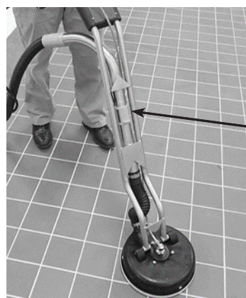
Cubierta del freno de aspiración
