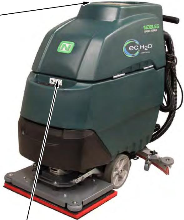
**ADHESIVO DE NIVEL DE CARGA DE LA BATERÍA** - situado en el lado inferior del depósito de recuperación.
