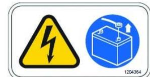
**ÉTIQUETTE D'AVERTISSEMENT - Risque électrique. Débranchez les câbles de la batterie avant l'entretien ou la réparation de la machine.**
