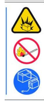
**ADHESIVO DE ADVERTENCIA:** Las baterías emiten hidrógeno. Existe peligro de incendio o explosión. Mantenga la máquina alejada de chispas y llamas cuando se esté cargando.
