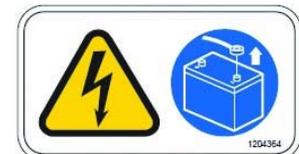
**ADHESIVO DE ADVERTENCIA:** Peligro eléctrico. Desconecte los cables de las baterías antes de realizar operaciones de mantenimiento en la máquina.
