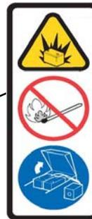
**ADVERTENCIA:** Peligro de incendio o de explosión. Las baterías emiten hidrógeno. Mantenga las chispas y llamas alejadas de la máquina. Mantenga el compartimento de la batería abierto mientras realiza la operación de carga.
