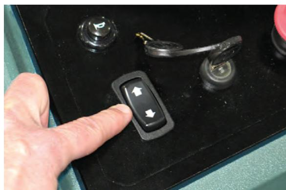
**REMARQUE :** Si les indicateurs lumineux du bouton directionnel clignotent rapidement, vérifiez que le pied droit n'appuie pas sur la pédale verte de mise en mouvement. La machine n'acceptera aucune commande du bouton directionnel si les indicateurs lumineux clignotent rapidement.
