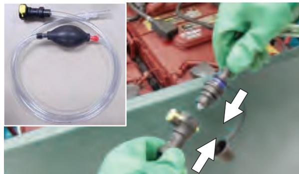
5. Immergez l'autre extrémité du tuyau de la pompe manuelle dans un bidon d'eau distillée.
