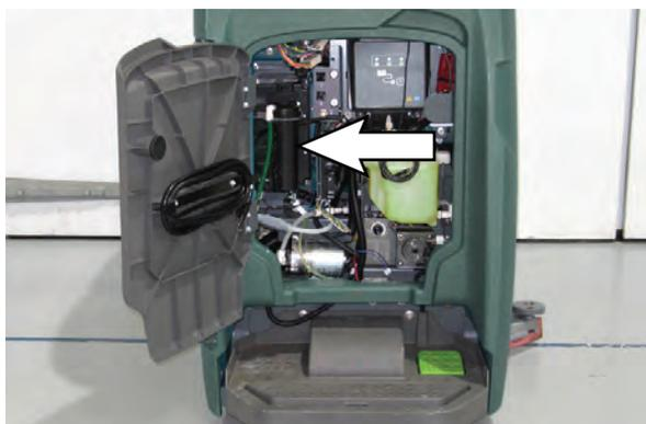
3. Déconnectez les deux connecteurs de tuyau du dessus de la cartouche en appuyant les colliers gris vers l'intérieur et en tirant les connecteurs vers l'extérieur. Soulevez la cartouche pour la retirer.
