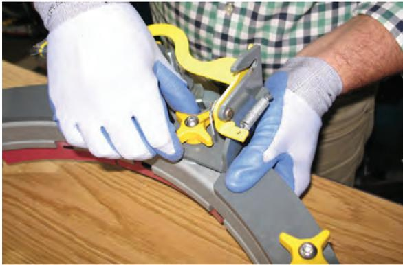
9. Placez la bride de fixation de bavette près du support de bavette et alignez les plots du support de bavette avec la bride de fixation de bavette.
