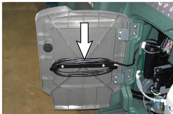
Pour les modèles équipés de chargeurs autonomes, branchez d'abord le cordon d'alimentation CC du chargeur sur la prise de charge des batteries, puis branchez le cordon d'alimentation CA sur une prise murale reliée à la terre. Reportez-vous au manuel du chargeur de batterie autonome pour les instructions d'utilisation. Ne fermez pas le réservoir de récupération sur les câbles du chargeur lors de la charge avec un chargeur autonome.
