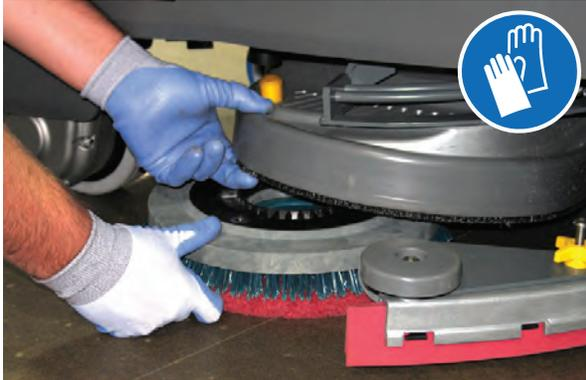
**Machines avec brosse à moyeux à 3 points de fixation :** Pour retirer la brosse ou le patin, attrapez le disque et faites le tourner rapidement.
