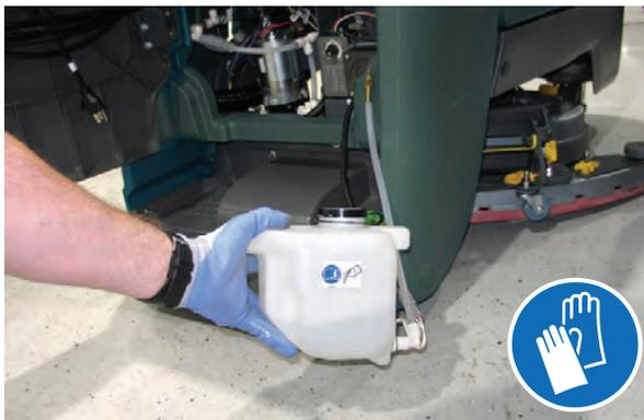
*REMARQUE : Retirez le réservoir pour conditions difficiles de la machine avant de le remplir afin d'éviter d'endommager les composants électroniques.*
