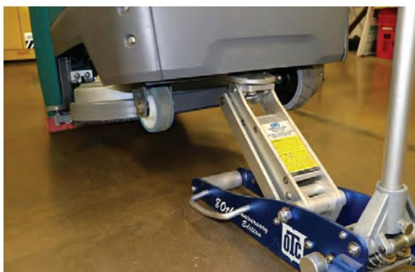
5. Placez une chandelle sous l'autre point de levage et abaissez la machine sur la chandelle de manière à ce que la chandelle et le cric supportent tous deux le poids de la machine.
