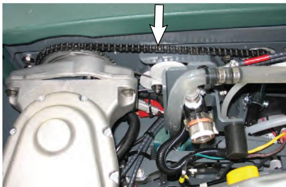
3. Inspectez le câble de direction pour vous assurer qu'il n'est pas endommagé ou usé. Utilisez la jauge de tension pour vérifier la tension du câble de direction.
