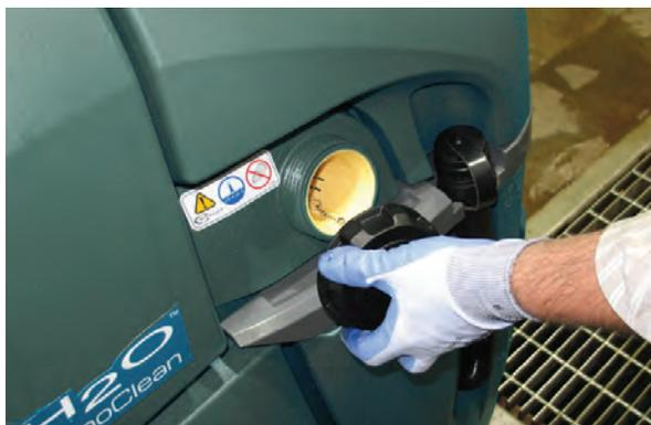
2. Insérez le tuyau de remplissage dans le filtre jaune et assurez-vous que le tuyau est maintenu en place dans le filtre.
