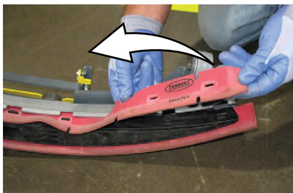
7. Faites pivoter la lame arrière pour obtenir un nouveau bord nettoyant et réinstallez la lame. Assurez-vous d'aligner les fentes sur la lame avec les languettes de retenue.
