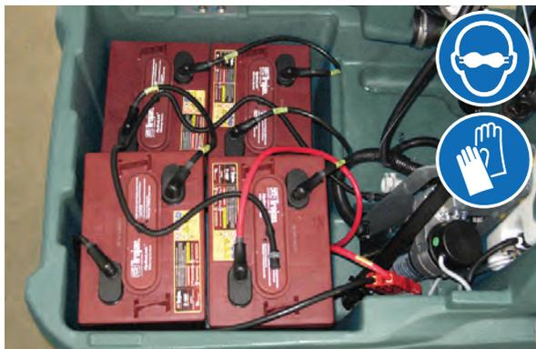
Vérifiez régulièrement le niveau d'eau du réservoir automatique de remise à niveau d'eau. Ajoutez de l'eau distillée si le niveau est bas.
