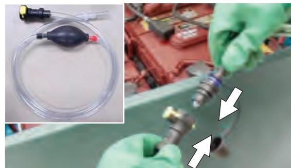
4. Immergez l'autre extrémité du tuyau de la pompe manuelle dans un bidon d'eau distillée.
