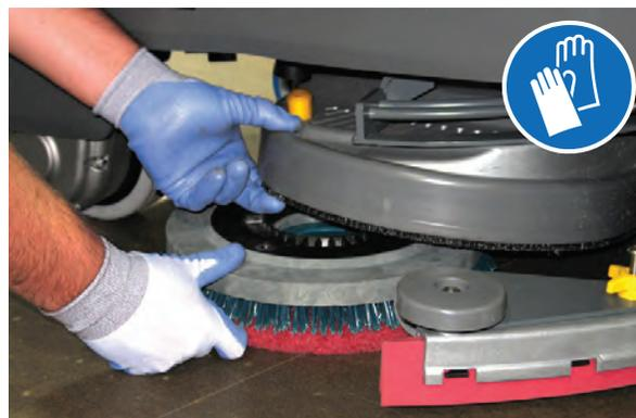
**Machines avec brosse à moyeux à 3 points de fixation :** Pour retirer la brosse ou le patin, attrapez le disque et faites le tourner rapidement.
