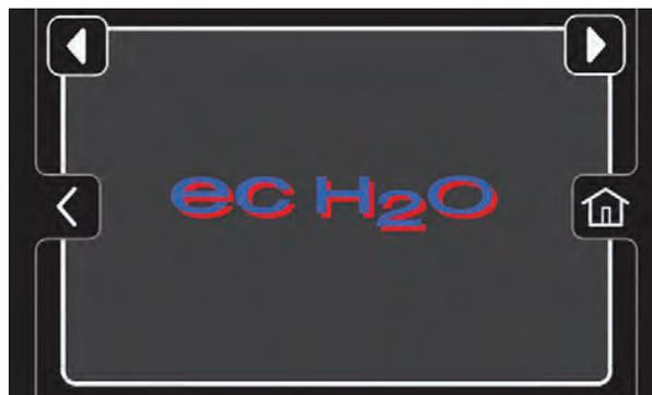
**Écran de panne ec-H2O jaune** - La machine a détecté un problème d'alimentation en eau ou de tuyauterie dans le système ec-H2O.
