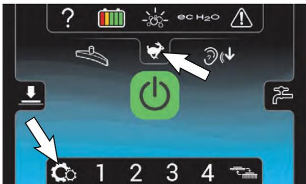
L'écran d'accueil du mode Opérateur ne permet pas d'accéder au bouton des réglages de la machine et au bouton de vitesse maximale de lavage.
