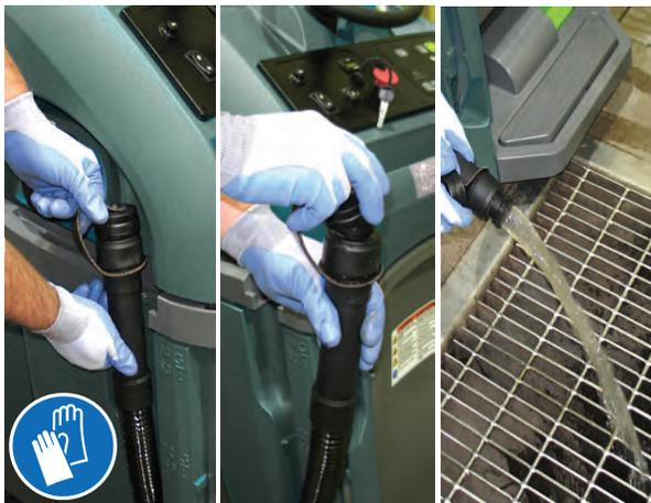
*REMARQUE : si vous utilisez un seau pour vidanger la machine, utilisez un seau différent pour remplir le réservoir de solution.*
