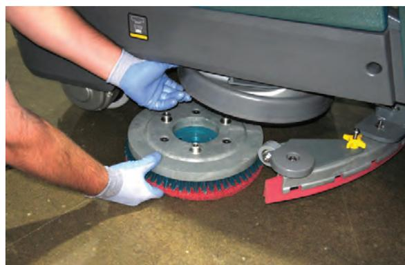
4. **Machines équipées de système d'entraînement magnétique :** Poussez la nouvelle brosse ou système d'entraînement de patin sous la tête de lavage et relevez la brosse ou le patin jusqu'à ce que l'aimant attache la brosse ou le patin au système d'entraînement.
