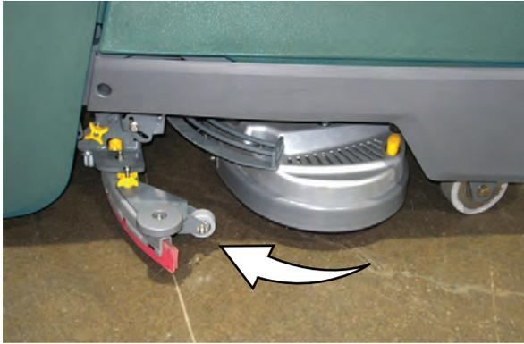
2. Fixez le patin sur le système d'entraînement avant d'installer le système. Verrouillez le patin en place à l'aide du bloqueur central.
