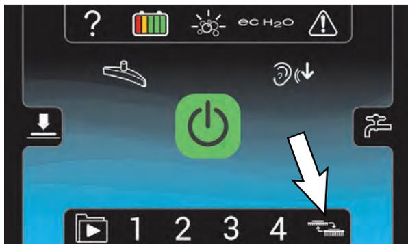
*REMARQUE : Restez sur la pédale de présence de l'opérateur jusqu'à ce que la tête de lavage se soit déplacée jusqu'au bout et ait arrêté de bouger. Le processus s'interrompt si la pédale de présence de l'opérateur est relâchée. Revenez sur la pédale de présence de l'opérateur et appuyez à nouveau sur le bouton de changement de brosse pour poursuivre le processus. Tournez la clé de contact sur la position OFF pour annuler le processus.*
