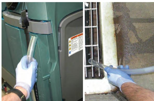
9. Option Conditions difficiles - Remplissez le réservoir Conditions difficiles avec un détergent recommandé à pleine concentration. Remettez le bouchon en place.
