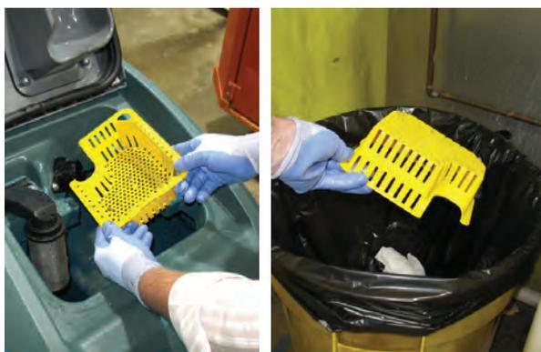
7. Retirez et nettoyez le filtre d'arrêt à flotteur.
