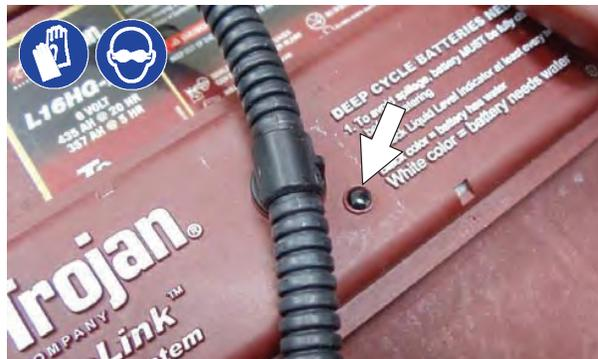
3. Repérez l'emplacement du raccord de connexion du tuyau de solution à l'intérieur du compartiment des batteries. Retirez le cache-poussière et connectez le tuyau de la pompe manuelle.
