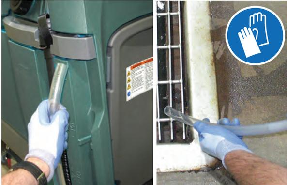
3. Rincez le réservoir de solution à l'eau claire. Rebranchez fermement le tuyau au réservoir de solution après le rinçage/vidange du réservoir.
