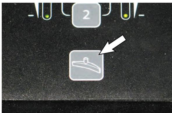
**Machines équipées de Pro-Panel :** Appuyez sur le bouton 1-STEP et ensuite sur le bouton de l'extracteur. Le bouton de l'extracteur s'éteint et l'extracteur s'arrête.
