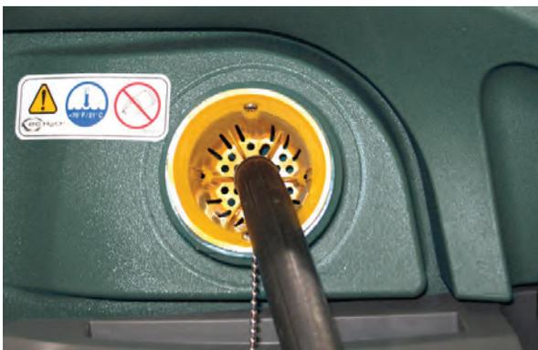
3. Remplissez le réservoir de solution jusqu'à ce que le niveau de l'eau atteigne la marque 53 l (14 gal) sur l'indicateur du réservoir de solution
