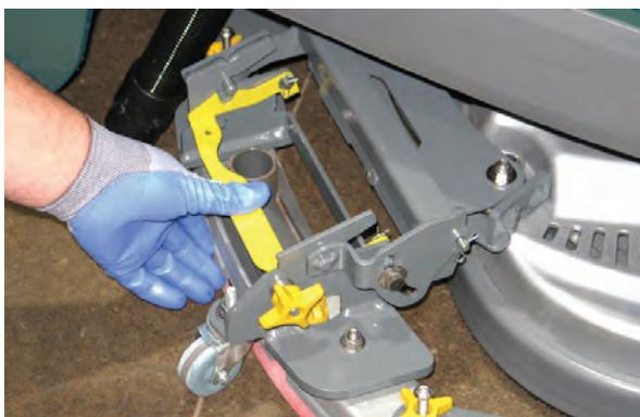
5. Desserrez complètement les deux boutons extérieurs du bloc de bavette. Cela séparera la retenue de la lame chargée par ressort du châssis de bavette.
