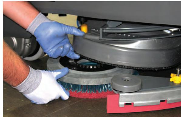
**Machines avec brosse à moyeux à 3 points de fixation** : Positionnez les trois attaches dans les fentes du moyeu de moteur et faites faire un tour rapide dans le sens inverse des aiguilles d'une montre au système d'entraînement du patin/de la brosse, pour que le moyeu s'engage.
