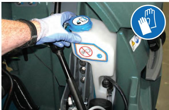
3. Enlevez le bouchon bleu du réservoir de remplissage automatique des batteries.
