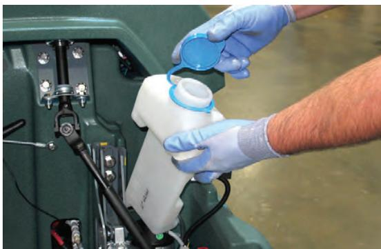
Pour les machines équipées de voyants d'électrolyte de batterie, l'indicateur de niveau monte et devient visible lorsqu'elles sont pleines. Il descend lorsqu'il est nécessaire d'ajouter de l'eau dans la machine.
