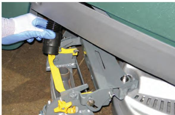
4. Appuyez sur le levier de retenue de la bavette et retirez l'assemblage de bavette de la machine.
