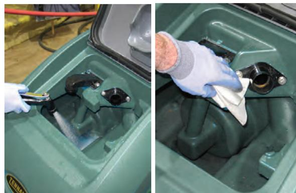
**POUR VOTRE SÉCURITÉ : Lorsque vous entretenez la machine, n'utilisez pas de jet de pression sur la machine. Un dysfonctionnement électrique risque de se produire. Utilisez un chiffon humide.**
