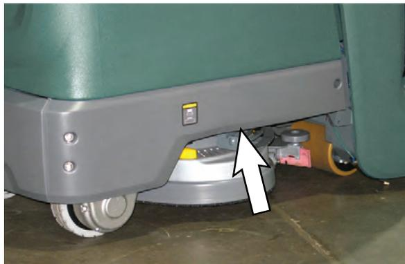
4. Placez le cric sous l'attache/point de levage et arrangez tous les tuyaux et câbles de manière à ce qu'ils ne soient pas écrasés lorsque la machine est soulevée du sol.
