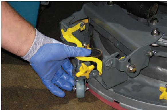
5. Desserrez complètement les deux boutons extérieurs du bloc de bavette. Cela séparera la retenue de la lame chargée par ressort du châssis de bavette.
