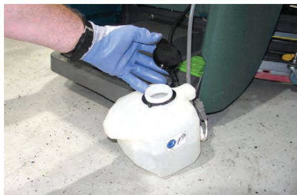
10. Option de remplissage automatique des batteries - Remplissez le réservoir avec de l'eau distillée. Remettez le bouchon en place.
