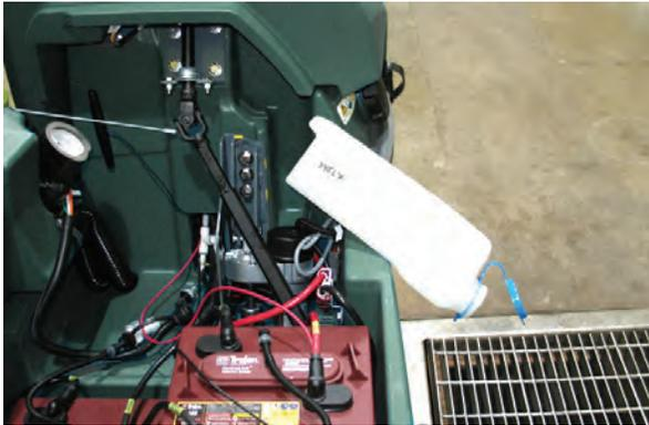
**IMPORTANT : NE PAS mettre d'antigel dans le réservoir de remise à niveau d'eau automatique des batteries.**
