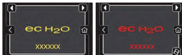
*REMARQUE : en cas de panne du système ec-H2O, la machine coupe automatiquement le système ec-H2O et passe en mode lavage classique. L'icône de l'indicateur d'entretien continue à clignoter jusqu'à ce que la panne de l'ec-H2O soit réparée.*
