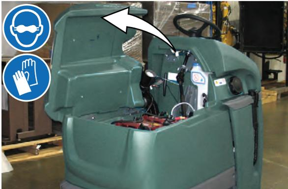
2. Placez avec précaution les batteries dans le chariot du compartiment de batteries de sorte que leurs bornes soient positionnées comme illustré.
