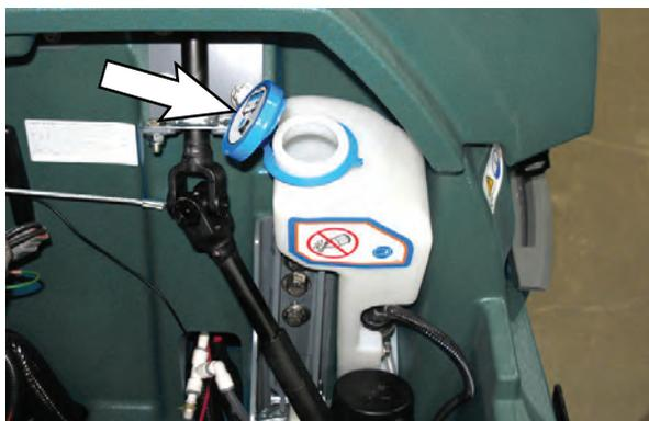
4. Versez de l'eau distillée dans le réservoir. Afin d'éviter de mettre de l'eau sur des composants sensibles, utilisez un entonnoir pour remplir le réservoir de remplissage automatique des batteries.
