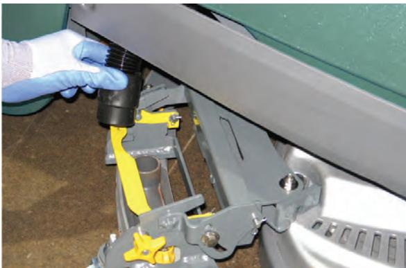
4. Comprima la palanca de retención de la bayeta y retire el conjunto de la bayeta de la máquina.
