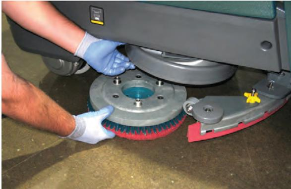
6. **Máquinas equipadas con ejes de cepillo magnéticos:** Inserte el cepillo o el portapad nuevos debajo del cabezal de fregado y levante el cepillo o portapad hasta que el imán los deje sujetos al eje de accionamiento.
