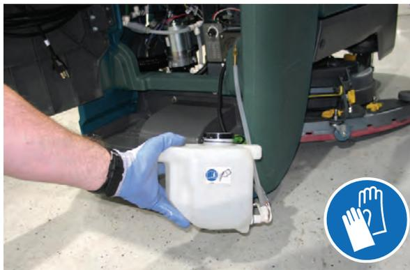
*NOTA: Retire el depósito Severe Environment de la máquina antes de llenarlo con detergente para evitar dañar los componentes electrónicos.*
