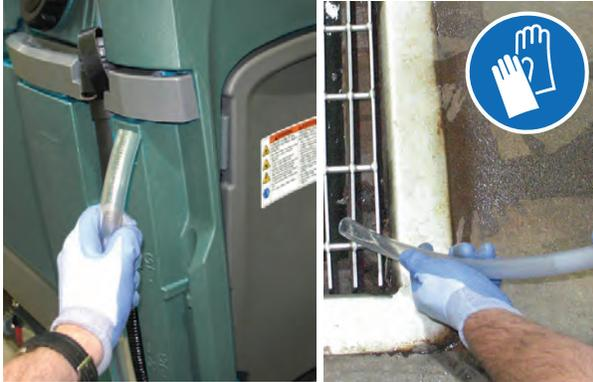
3. Enjuague el depósito de solución con agua limpia. Vuelva a conectar firmemente la manguera al depósito de solución tras enjuagar / vaciar el depósito.
