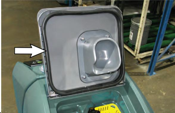
2. Vacíe el depósito de la disolución. Retire y limpie el filtro del depósito de solución. Gire el vaso del filtro en sentido contrario a las agujas del reloj para sacarlo.
