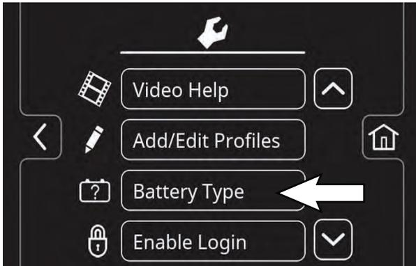
4. Seleccione el tipo y la marca de la batería instalada en la máquina. Consulte la etiqueta de la batería para saber el tipo y la marca. Pulse las flechas arriba y abajo para navegar por la lista de selección de baterías.
