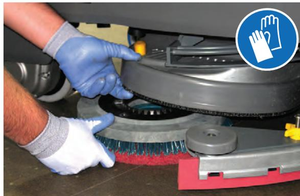
**Máquinas equipadas con ejes de cepillo de 3 lengüetas:** Para quitar el cepillo o portapad, sujete el disco y gírelo en un movimiento rápido.
