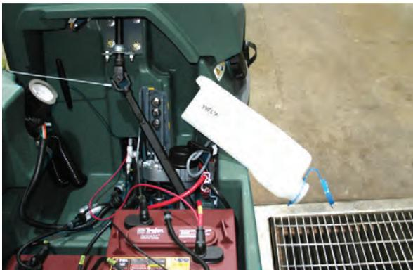
**IMPORTANTE:** NO añada anticongelante al depósito de rellenado automático de la batería.
