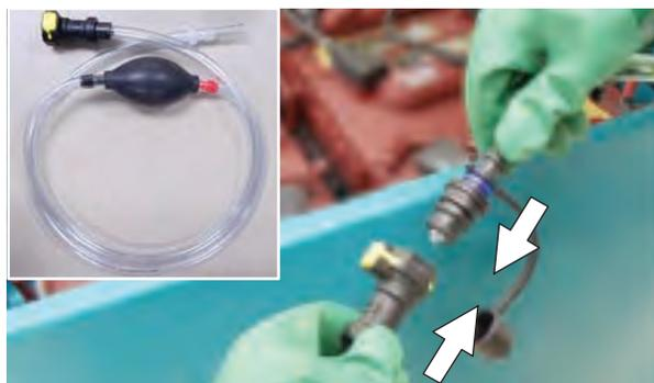
5. Sumerja el otro extremo de la manguera de la bomba manual en una botella de agua destilada.
