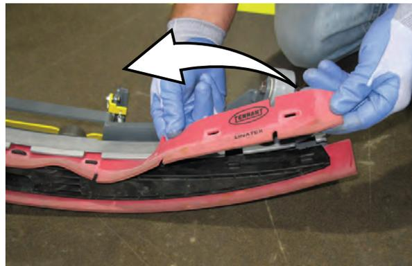
7. Gire las láminas traseras para obtener un nuevo borde de secado y vuelva a montar las láminas. Asegúrese de alinear las ranuras en las láminas con las pestañas de sujeción.
