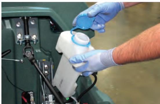
Para las máquinas equipadas con indicadores de electrolitos de la batería, el flotador blanco se elevará y se hará visible cuando estén llenas. Bajarán cuando se necesite agua.
