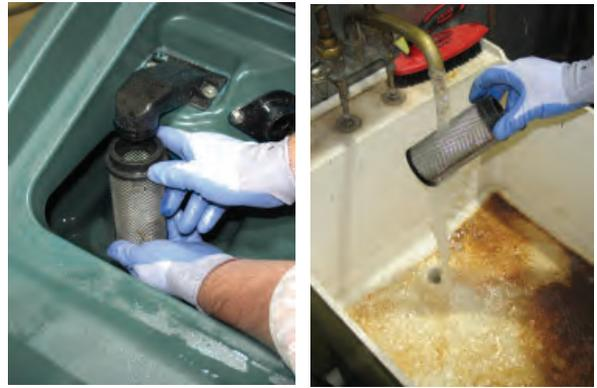
8. Vacíe y aclare el depósito de disolución.
