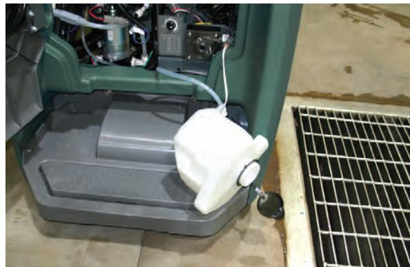
4. Modelos no equipados con sistema ec-H2O: encienda la máquina y active el sistema de flujo de solución. Apague la máquina cuando empiece a ver el anticongelante en el suelo.
