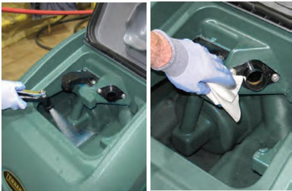
**PARA SU SEGURIDAD:** Cuando repare la máquina, no moje la máquina rociándola o utilizando una manguera. Pueden producirse fallos eléctricos. Utilice un paño húmedo.
