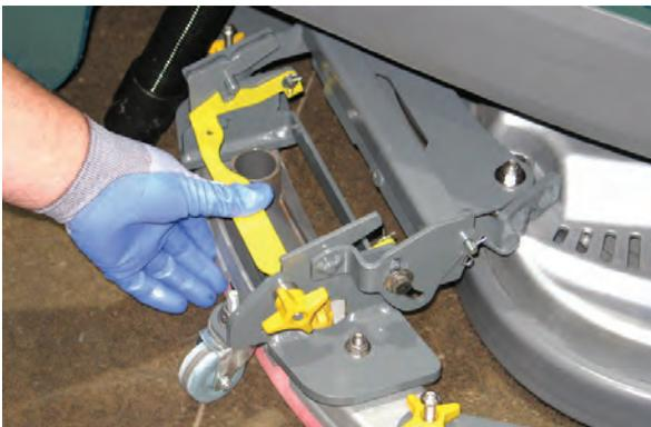
5. Afloje completamente los dos botones exteriores del conjunto de la bayeta. La sujeción de las láminas cargada por resorte se soltará del chasis de la bayeta.
