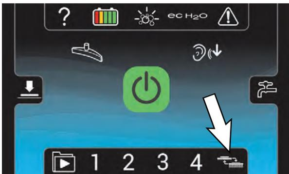
*NOTA: Permanezca de pie sobre el pedal de presencia del operador hasta que el cabezal de fregado haya completado todo un ciclo y se detenga. El proceso se quedará en pausa si se suelta el pedal de presencia del operador. Vuelva a pisar el pedal de presencia del operador y a pulsar de nuevo el botón de cambio de cepillo para continuar el proceso. Gire el interruptor a la posición de apagado para cancelar el proceso.*
