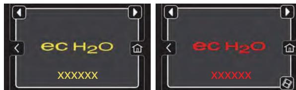
*NOTA: Si se produce un fallo en el sistema ec-H2O, la máquina desactiva automáticamente el sistema ec-H2O y pasa al modo de fregado convencional. El botón del indicador de servicio seguirá parpadeando hasta que se repare el fallo en el sistema de ec-H2O.*
