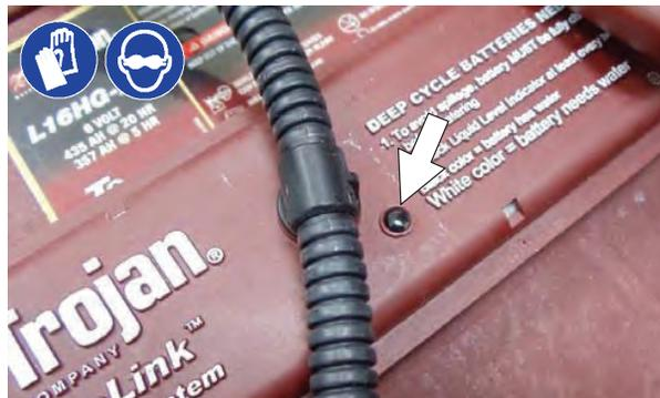
3. Localice el acoplador de la manguera de llenado de la batería en el interior del compartimento de la misma. Quite el capuchón antipolvo y conecte la manguera de la bomba manual.
