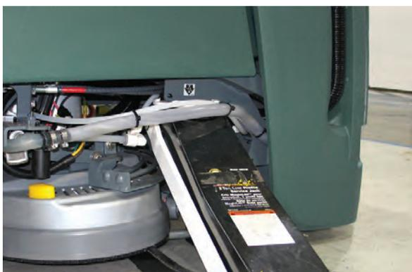
5. Use un gato hidráulico para levantar la máquina del suelo.
