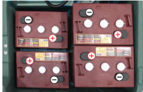
3. Utilizando los fuelles para bornes de batería que se suministran, conecte los cables a los bornes de la batería, el ROJO AL BORNE POSITIVO (+) y el NEGRO AL BORNE NEGATIVO (-). Apriete las conexiones de los cables a las baterías conforme a las especificaciones del fabricante de la batería.
