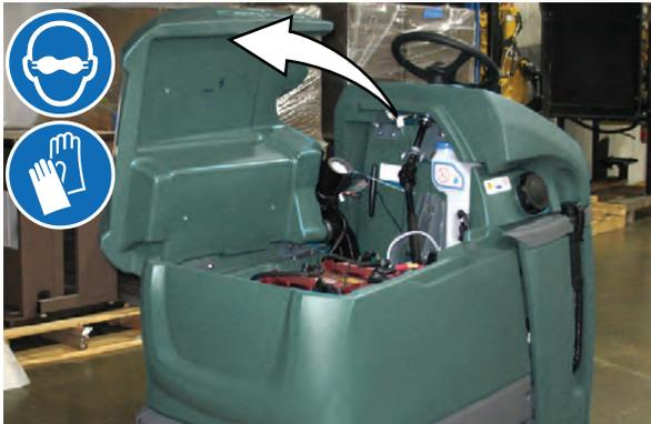
2. Monte con cuidado las baterías en la bandeja del compartimento de la batería y coloque los bornes de la batería como se indica.
