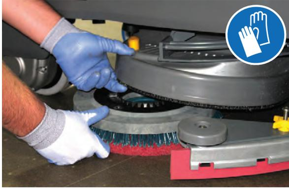
**Máquinas equipadas con ejes de cepillo de 3 lengüetas:** Para quitar el cepillo o portapad, sujete el disco y gírelo en un movimiento rápido.
