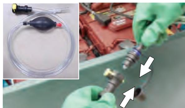
4. Sumerja el otro extremo de la manguera de la bomba manual en una botella de agua destilada.
