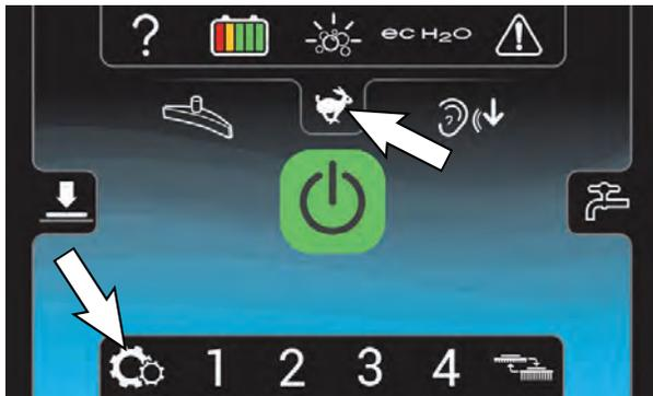
La pantalla de inicio del modo de operario limita el acceso al botón de configuración de la máquina y al botón de velocidad de fregado máxima.
