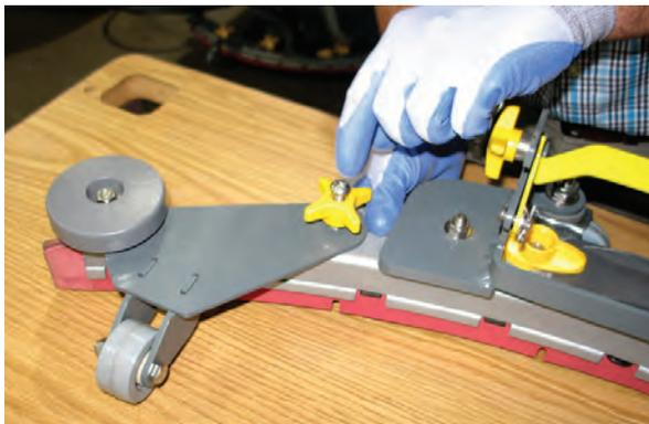
9. Coloque el soporte del conjunto de la bayeta cerca del carro de la bayeta y alinee los pasadores del carro con el soporte del conjunto de la bayeta.
