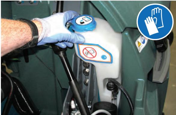
3. Quite el tapón azul del depósito de rellenado automático de agua de la batería.
