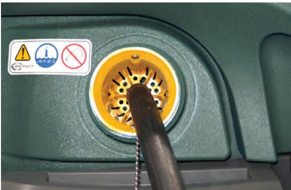
3. Llene el depósito de solución con agua hasta que el nivel llegue a la marca de 53 L (14 G) del indicador del depósito de solución.
