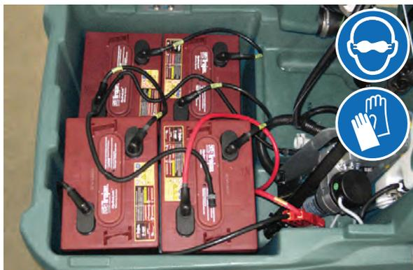
Compruebe el nivel de agua del depósito de rellenado automático periódicamente. Añada agua destilada cuando el nivel esté bajo.
