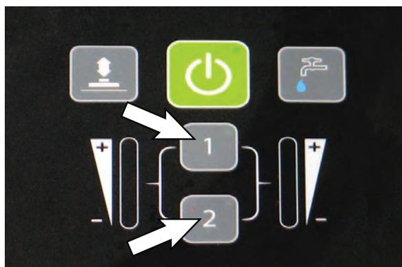
Para preconfigurar los botones de control de zona para las diferentes aplicaciones de fregado, seleccione los ajustes deseados de la siguiente lista y, a continuación, mantenga pulsado el botón de zona hasta que el LED verde parpadee tres veces en señal de que se ha guardado la configuración. Para predefinir la zona 3, mantenga pulsados los botones 1 y 2 a la vez.
