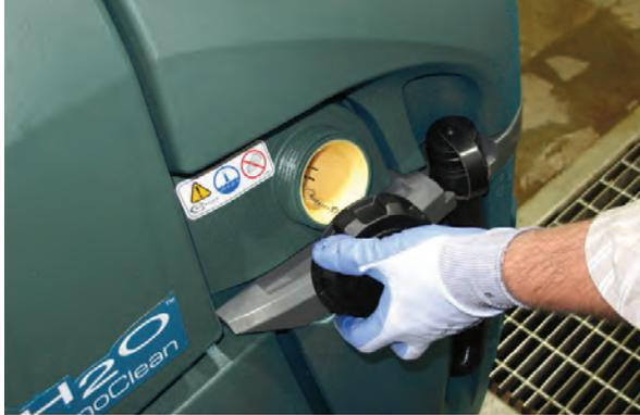
2. Inserte la manguera de llenado en el filtro amarillo y compruebe que la manguera queda bien sujeta en el filtro.
