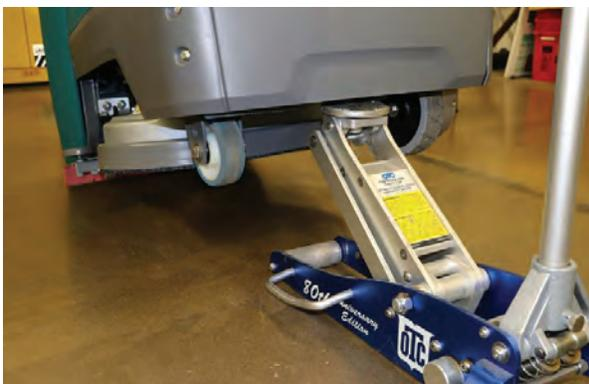
5. Coloque un gato estabilizador bajo el otro punto de enganche y baje la máquina sobre el gato estabilizador, de modo que el gato estabilizador y el gato sustenten el peso de la máquina.
