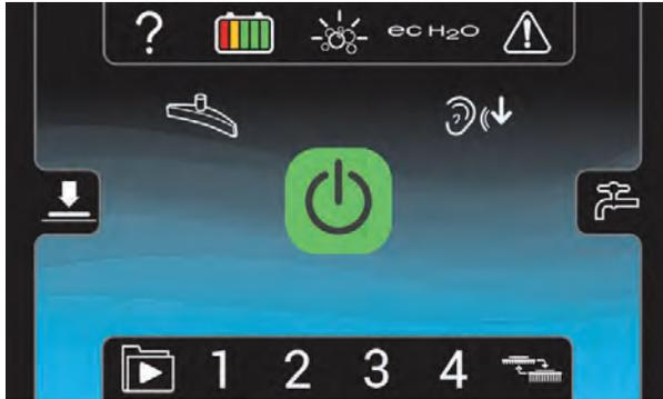
**Modo de supervisor:** capacidad de utilizar la máquina con un uso total de todos los controles, junto con la configuración de permisos y restricciones para el modo de operario así como de inicio de sesión. La pantalla de inicio del modo de supervisor da acceso al botón de configuración de la máquina y al botón de velocidad de fregado máxima.
