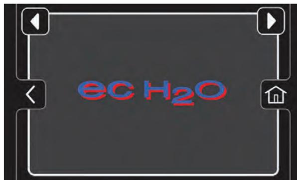
**Pantalla de fallo ec-H2O amarilla:** la máquina ha detectado un fallo de la bomba o del agua en el sistema de ec-H2O.
