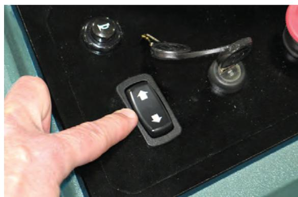
**NOTA:** Si las luces del interruptor de avance / marcha atrás parpadean rápidamente, asegúrese de que el pie derecho no está pisando el pedal de avance verde. La máquina no aceptará la señal del interruptor de avance / marcha atrás si las luces parpadean rápidamente.
