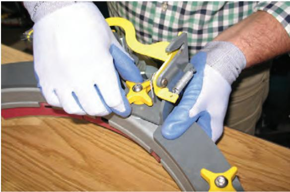
9. Coloque el soporte del conjunto de la bayeta cerca del carro de la bayeta y alinee los pasadores del carro con el soporte del conjunto de la bayeta.
