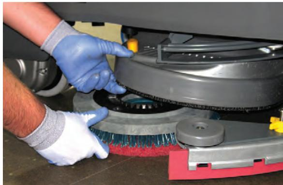
**Máquinas con ejes de cepillo de 3 lengüetas:** Coloque las tres lengüetas en las ranuras del eje del motor y gire el portapad/cepillo en un movimiento rápido hacia la izquierda para acoplar el eje.
