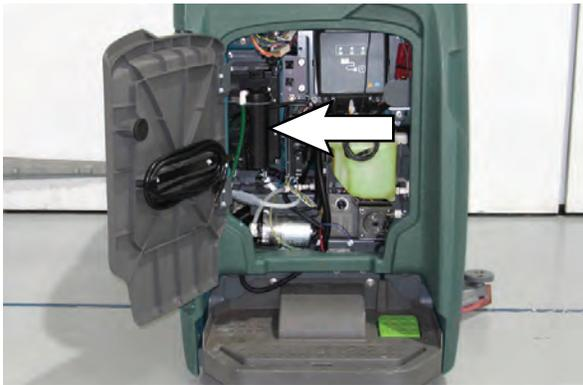
3. Desconecte los dos conectores de manguera de la parte superior del cartucho apretando los aros grises hacia adentro y tirando de los conectores hacia afuera. Levante el cartucho para desmontarlo.
