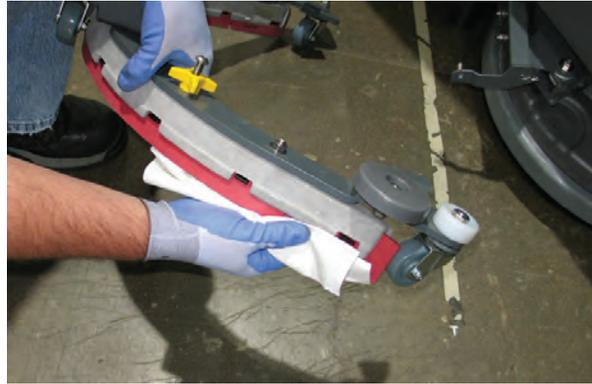
4. Limpie la aleta del cabezal de fregado. Compruebe si hay está deteriorada o gastada. Sustitúyala si está gastada o deteriorada.
