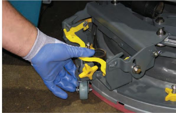
5. Afloje completamente los cuatro botones del conjunto de la bayeta. La sujeción de las láminas cargada por resorte se soltará del chasis de la bayeta.
