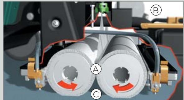
**A)** Les rouleaux de transfert de la saleté humides agrippent la saleté des fibres du tapis et la soulèvent dans l'appareil.
